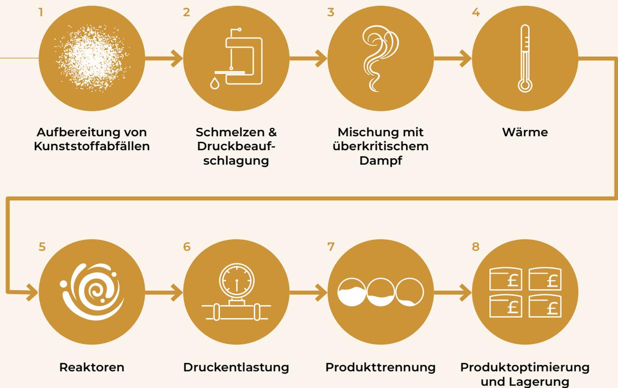
Zu Beginn des Prozesses werden die gemischten Kunststoffabfälle zerkleinert und unerwünschte Verunreinigungen wie Glas, Splitt, Metall und Steine entfernt.
